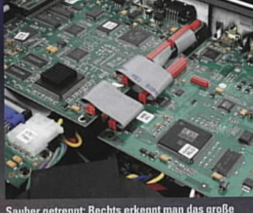
Sauber getrennt: Rechts erkennt man das große Videoboard. Links daneben liegt die Digital-Audio-Platine, deren DSP passiv gekühlt wird
